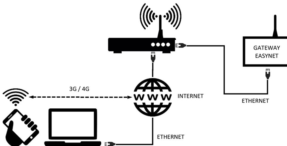
Abbildung 4.4. Anschlussschema des Modus LAN-ETHERNET. Beispiel für einen Fernzugriff über das Internet.
