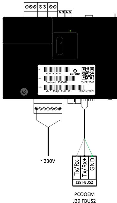
**Abbildung 3.1.** Verbindung des GATEWAY EASYNET mit dem ECOFOREST-Gerät.
