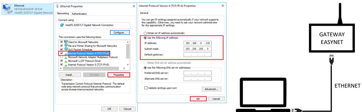
**Abbildung 4.1.** Anschlussschema des Modus DIRECT-ETHERNET. Beispiel eines Direktanschlusses per Kabel.
