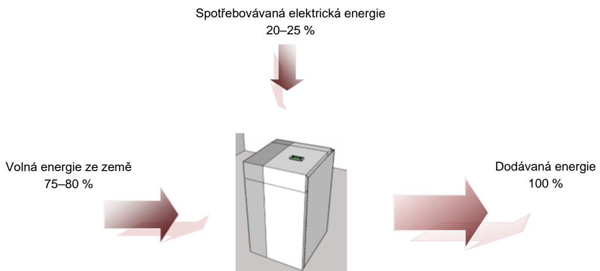
Obrázek 2.1. Provoz zemního tepelného čerpadla za běžných podmínek
