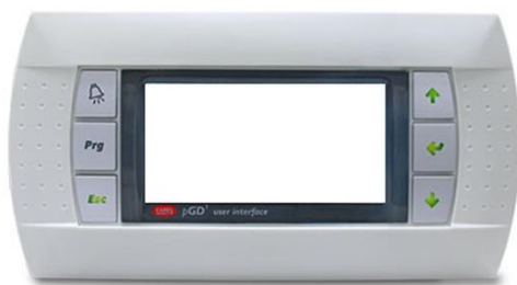
Figura 4.1. Terminale di controllo pGD1.
